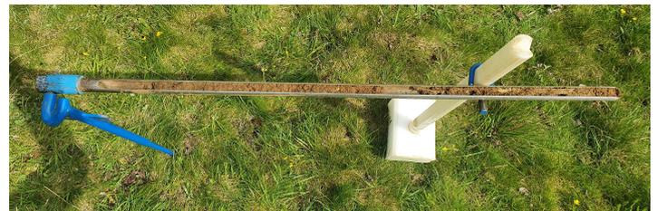
Abbildung des zum Einsatz kommenden "Pürckhauer"-Bohrstock
